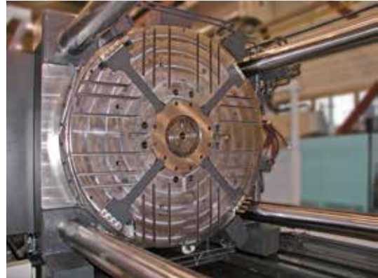
Verriegelungs-Blockzylinder für Drehscheibe, Temperaturbereich max. 70 °C.
