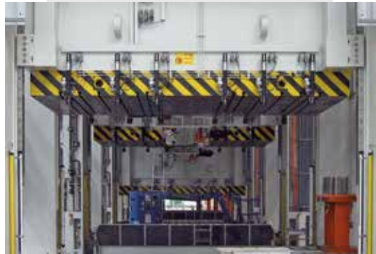
Spannelemente an einer Transfer-Großpresse der Fa. Schuler.
