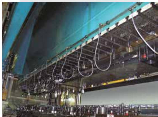
Spannelemente an einer Transfer-Großpresse der Fa. Schuler.
